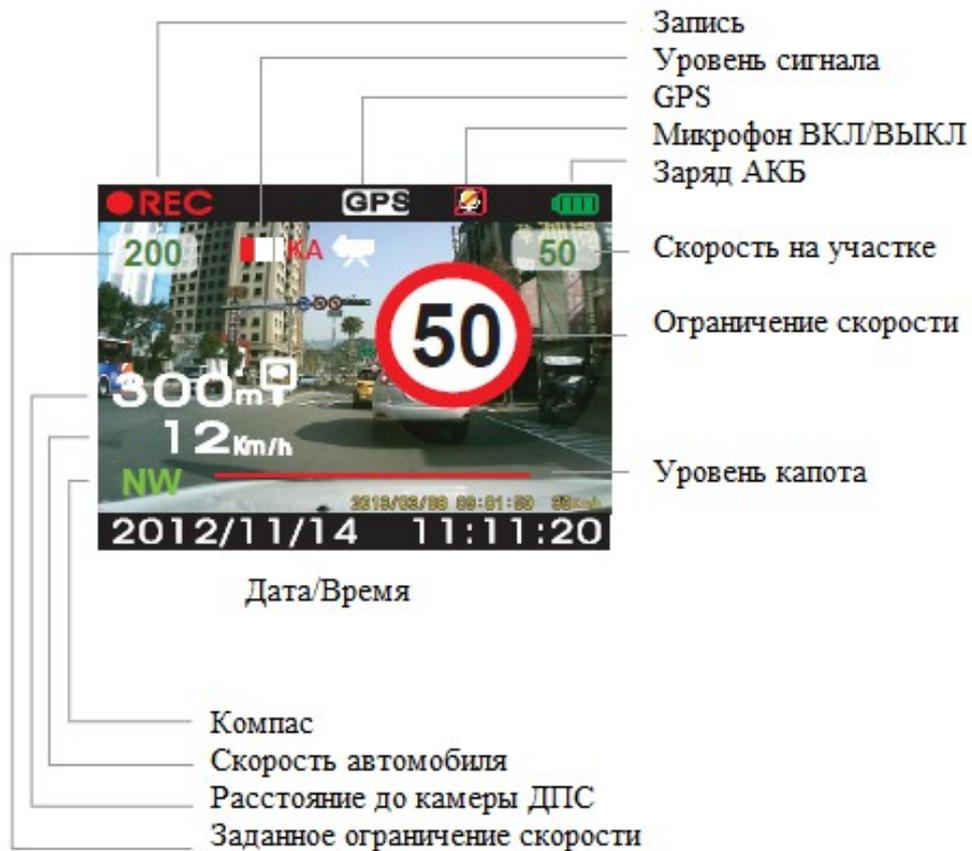
После того, как вы правильно установили все части прибора, включите зажигание и заведите двигатель. На экране появится изображение от видеокamеры прибора и символы о дате, времени, скорости и GPS. Появление символа радара означает, что прибор готов принимать сигналы радарного датчика.
