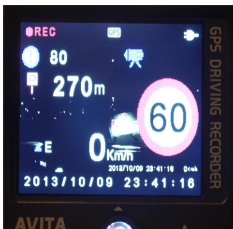
В случае не соответствия скорости вашего автомобиля разрешенной скорости на участке, будет подано голосовое оповещение о превышении скорости. По окончании зоны действия камеры будет подан мелодичный сигнал. Если же камера работает в оба направления, то после отметки расстояния «0» начнется отсчет в прямом порядке до окончания зоны фиксации. И только после этого будет подан мелодичный сигнал, означающий, что вы вышли из зоны контроля.
